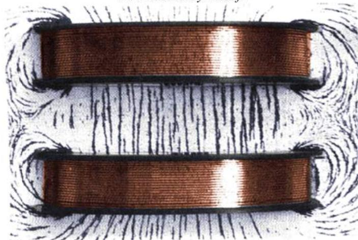
Représentation du champ magnétique au niveau de deux bobines alimentées par un courant alternatif
