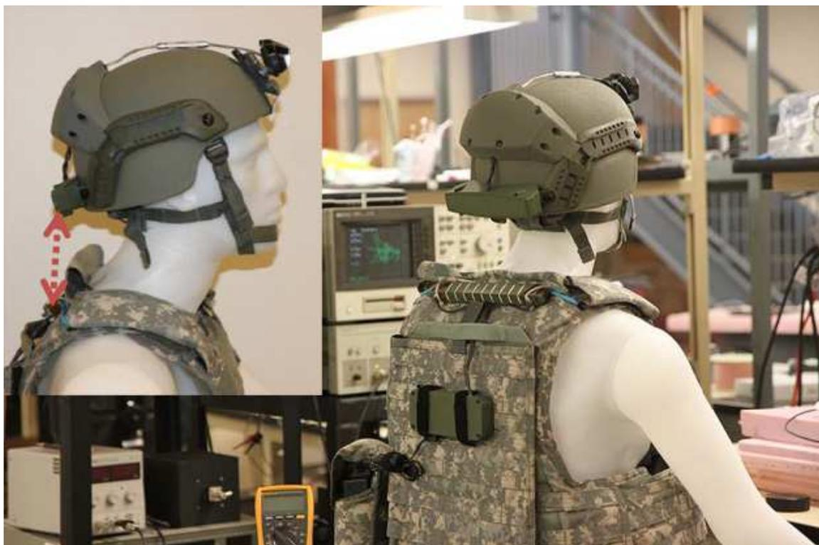
Prototypé de gilet équipé de la technologie WiTricity
