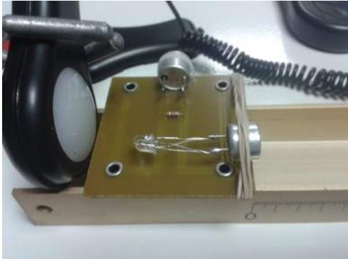
Le capteur du luxmètre et le récepteur
