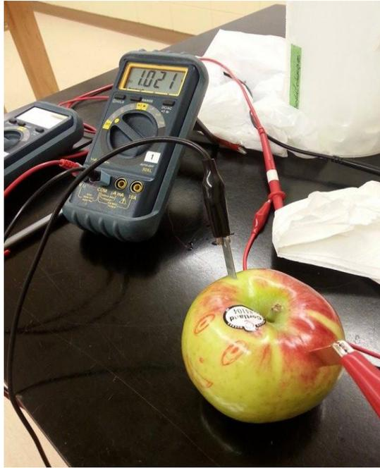
**Fig.3 :** Montage effectué en laboratoire pour le test des résistances avec une pile aux fruits.
