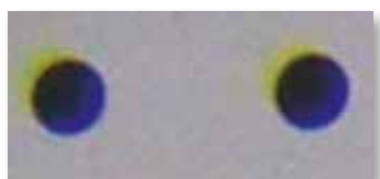
▲ Aberration chromatique, ou comment les débordements de la couleur diminuent la résolution.
